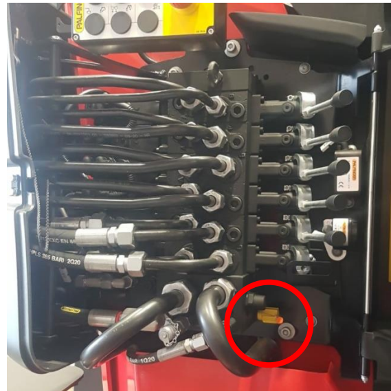
בורר ראשי (סלקטור) הכולל ברז העברה למוז חירום (עם חותם) בעגורן תוצרת פלפינגר (מסומן בעיגול אדום)
