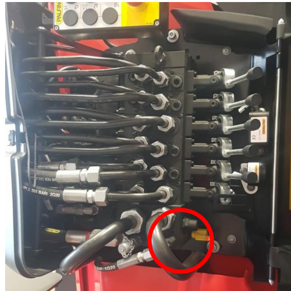
בורר ראשי (סלקטור) הכולל ברז העברה למוד חירום (עם חותם) בעגרון תוצרת פלפינגר (מסומן בעיגול אדום)
