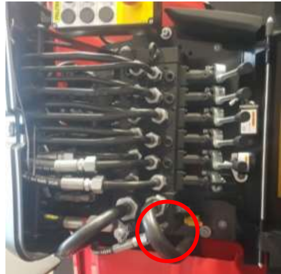
תמונה מס' 3: בורר ראשי (סלקטור) הכולל ברז העברה למוד חירום (עם חותם) בעגורן תוצרת פלפינגר (מסומן בעיגול אדום)
