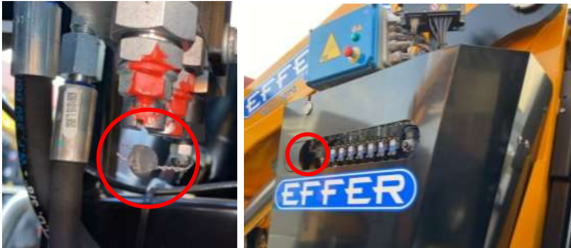
תמונה מס' 1: בורר ראשי (סלקטור) הכולל פורק לחץ (עם חותם) בעגורן תוצרת EFFER (מסומן בעיגול אדום)
